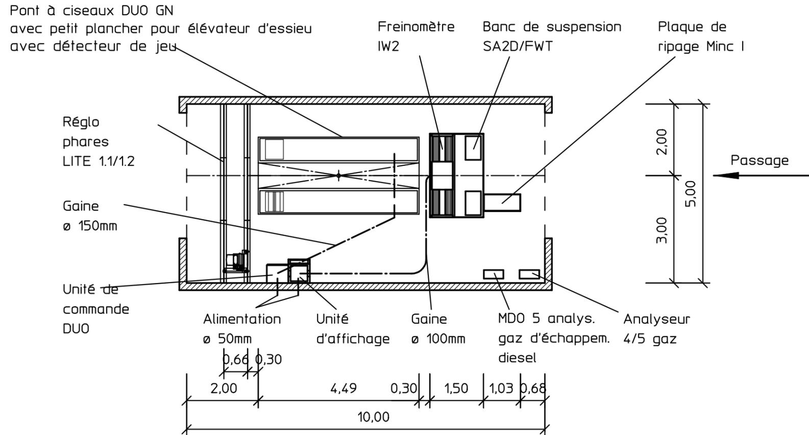
Au cas où plus de deux lignes de vérification sont installées, nous recommandons de loger les câbles transmettant des données ou du courant dans des conduites de câbles séparées.
