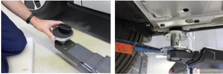
Das Aufnahmetellersystem (ATS) mit formschlüssigen Fahrzeugadaptern im Einsatz Fotos: MAHA
