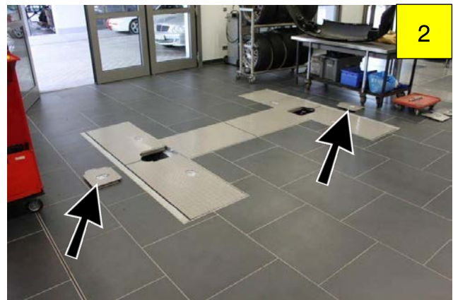
2 Beide Stempelabdeckungen entfernen und aufbewahren.
