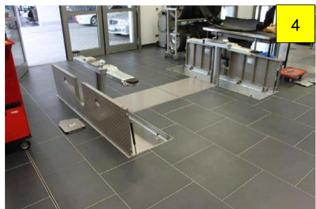
4 Hebebühne über die Oberkante der geöffneten Klappdeckel (ca. 1 m Hubhöhe) fahren.
